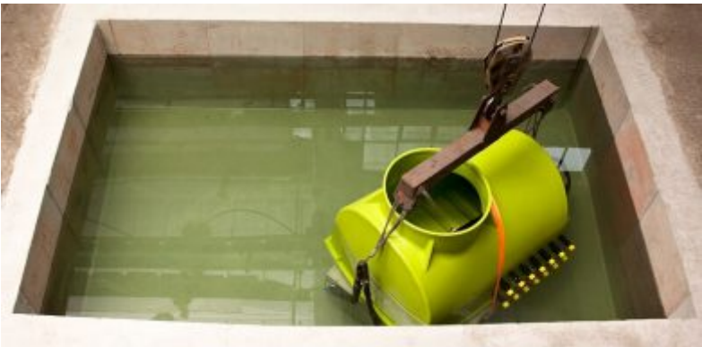
Tlaková zkouška každé vyrobené šachty.
